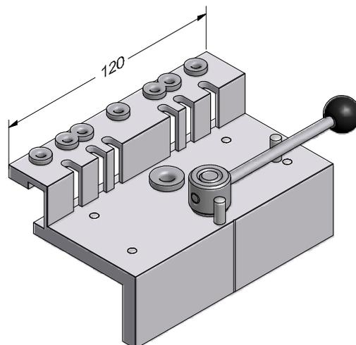
Шаблон для механического соединения,
