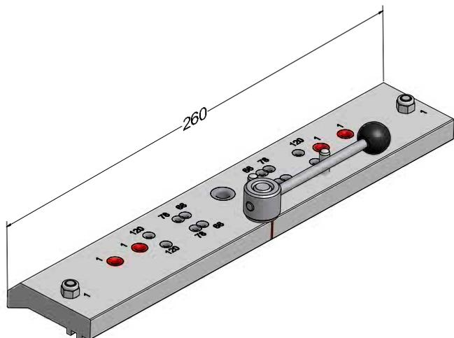
Шаблон для механического соединения
