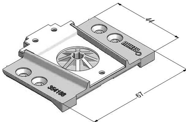
Механический соединитель импоста 78 и створки Z57,
